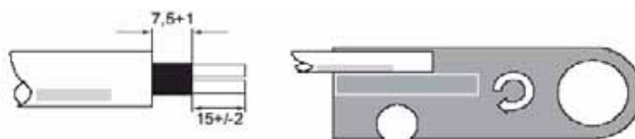
Рисунок 4 - 4 Длина снятия изоляции на кабеле PROFIBUS DP
